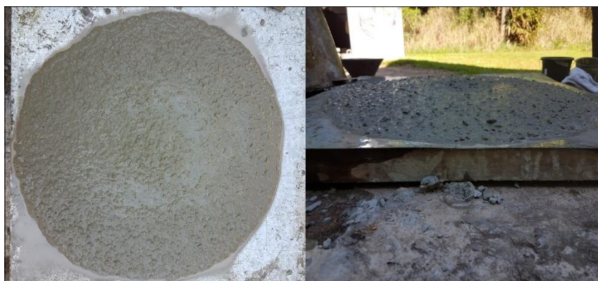
Figura 72 - Concreto Teste_B 3/8 C após ensaio de espalhamento
