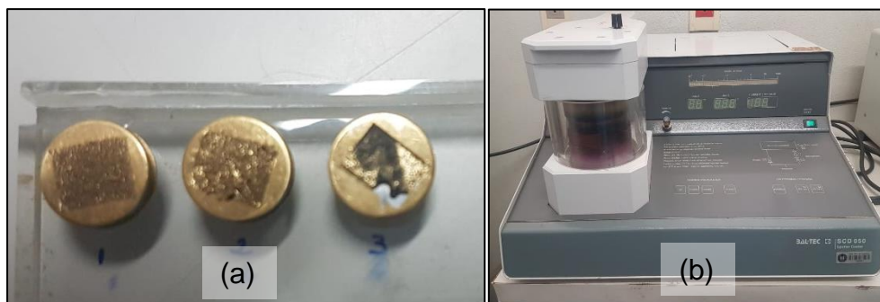
Figura 33 – Detalhes da preparação das (a) amostras e do (b) equipamento metalizador
