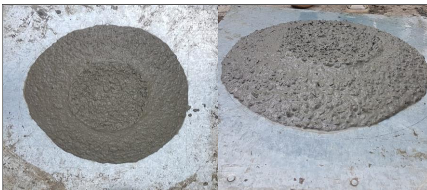
Figura 71 - Concreto Teste_ B 3/8 A após ensaio de espalhamento
