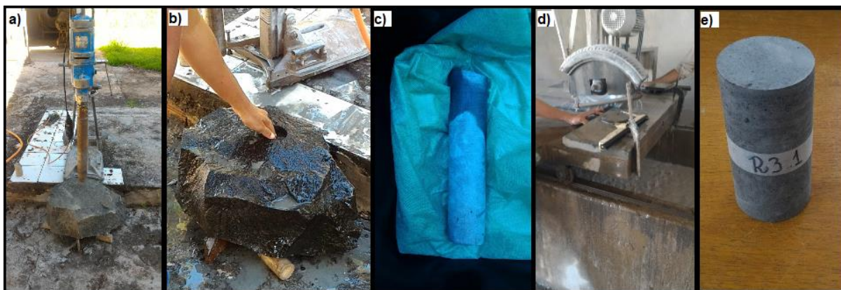
Figura 37 - a) Extração do testemunho com uma perfuratriz; b) retirada do testemunho da rocha; c) testemunho após extração; d) retificação do corpo de prova; e) corpo de prova pronto
