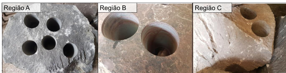
Figura 38 - Fotos das rocha após extração dos testemunhos
