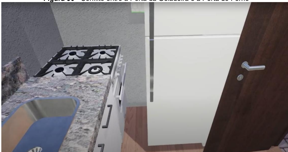
Figura 30 - Conflito entre a Porta da Geladeira e a Porta do Forno
