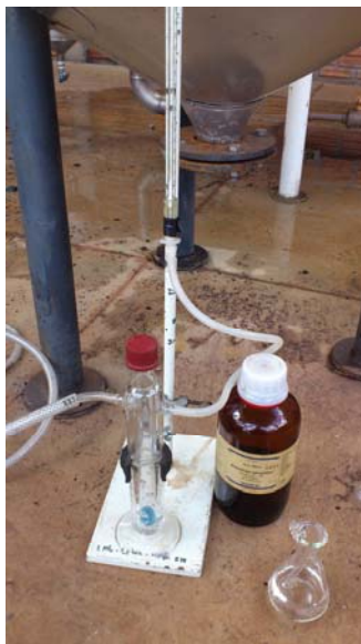
Figura 27 – Fotografia do sistema de coleta de alcatrão.
