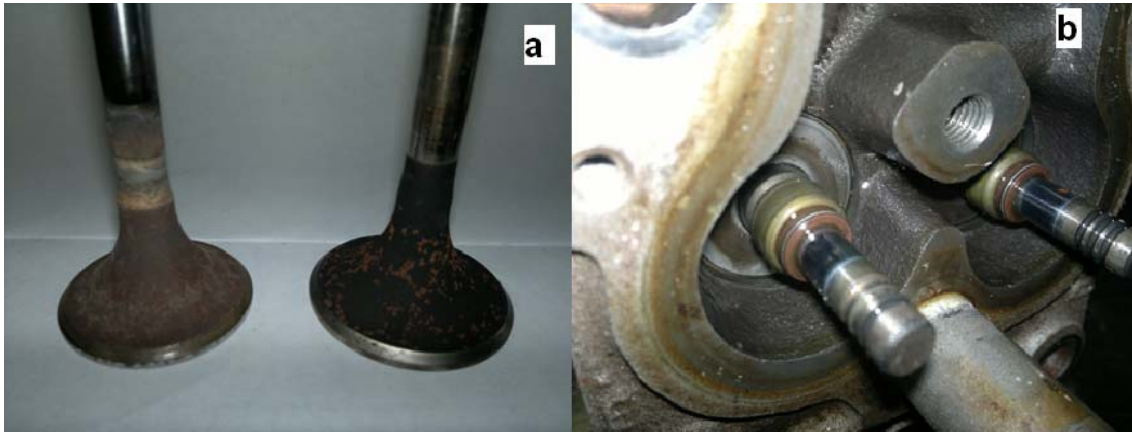
Figura 44 – Válvulas de admissão e escape (a) e haste da válvula (b) do motor após 46 horas de funcionamento
