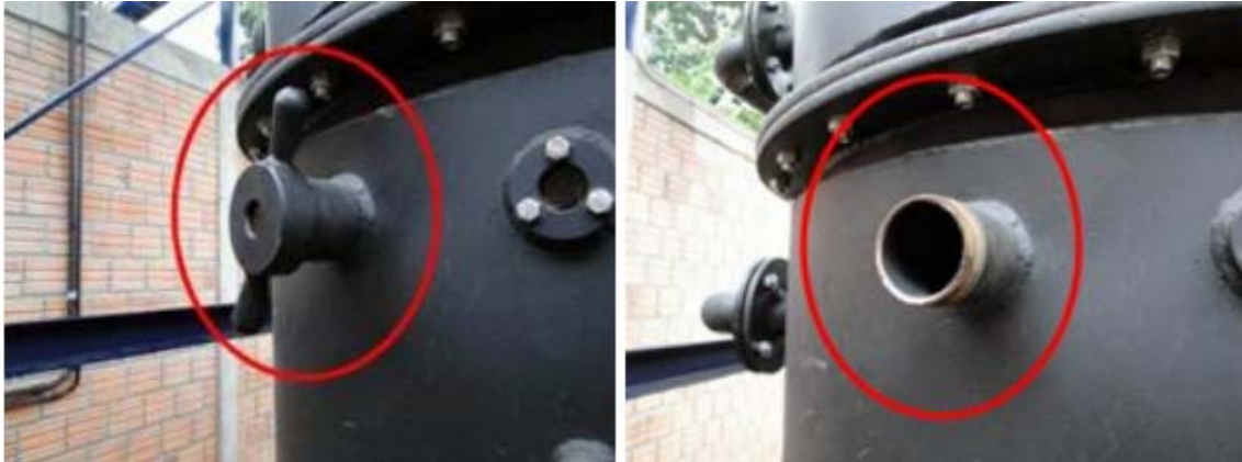
Figuras 23 e 24 – Bocal de partida com a tampa (23) e sem a tampa (24), respectivamente
