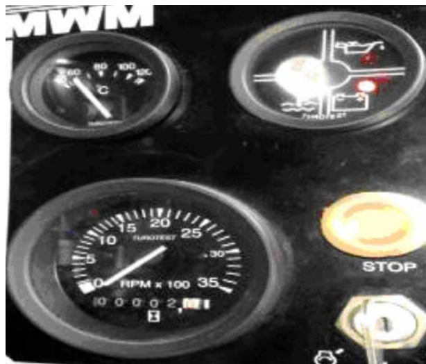
Figura 22 – Painel de indicadores do motor e ignição
