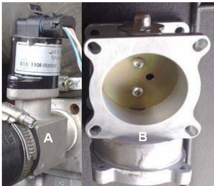
Figura 23 – a) Misturador de combustível do motor utilizado b) Corpo Borboleta do motor utilizado
