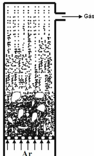
Figura 6 – Esquema de um gaseificador de leito borbulhante
