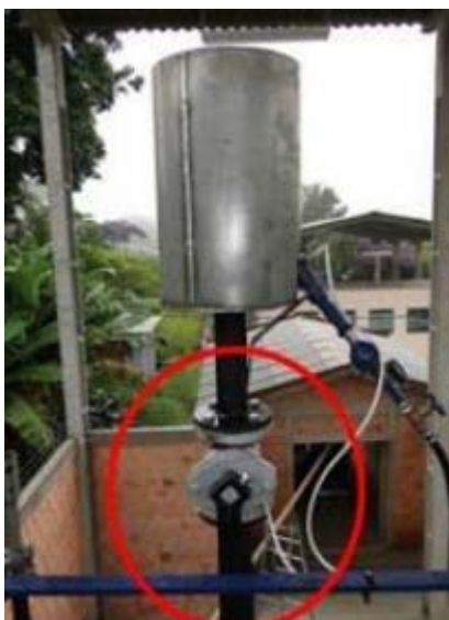
Figura 10 – Válvula do “Flare”
