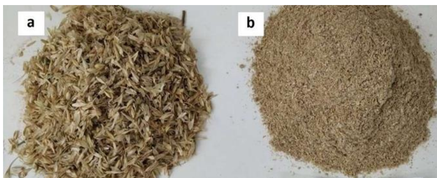
Figura 12 – a) resíduo extraído da pré-limpeza b) resíduo moído.
