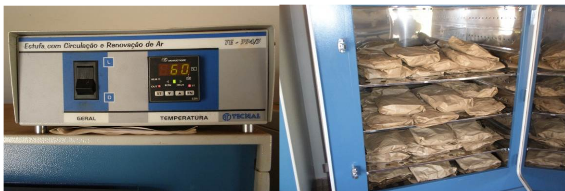
Figura 5.11 – Painel de Controle e Estufa Tecnal Mod. TE – 394/3
