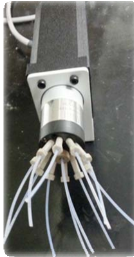
Figura 8 - Válvula seletora de 10 vias utilizada como injetor
