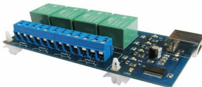
Figura 6 - Módulo USB (PUSB-4RL) utilizado para ligar e desligar os reles
