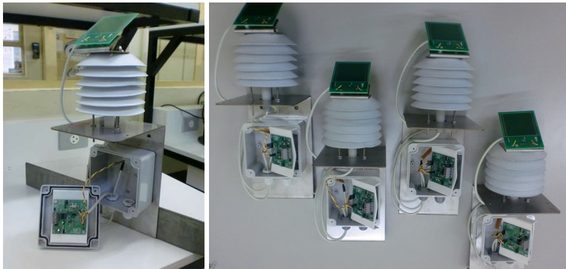
Figura 4.16: Controle de alimentação implementado.
