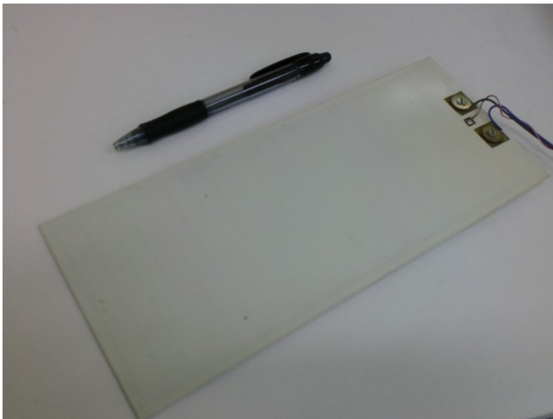
Figura 4.1: Sensor capacitivo fabricado para testes de validação.
