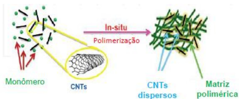
Figura 12. Representação da polimerização in situ de um nanocompósito
