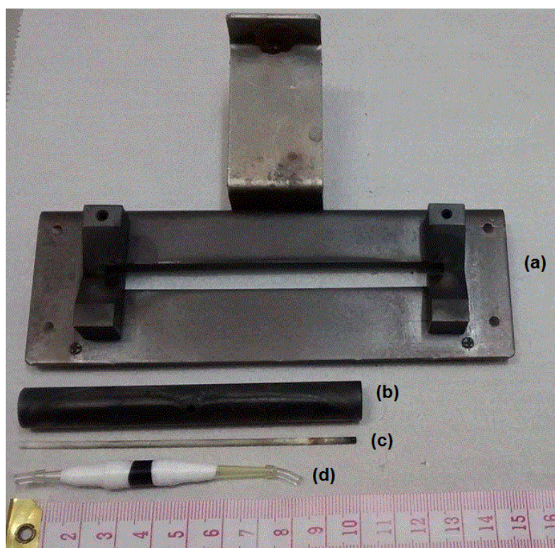
Figura 2.1 Medidas dos acessórios do sistema de pré-concentração (a) Suporte tubo de níquel; (b) forno tubular de níquel; (c) capilar cerâmico e (d) minicoluna
