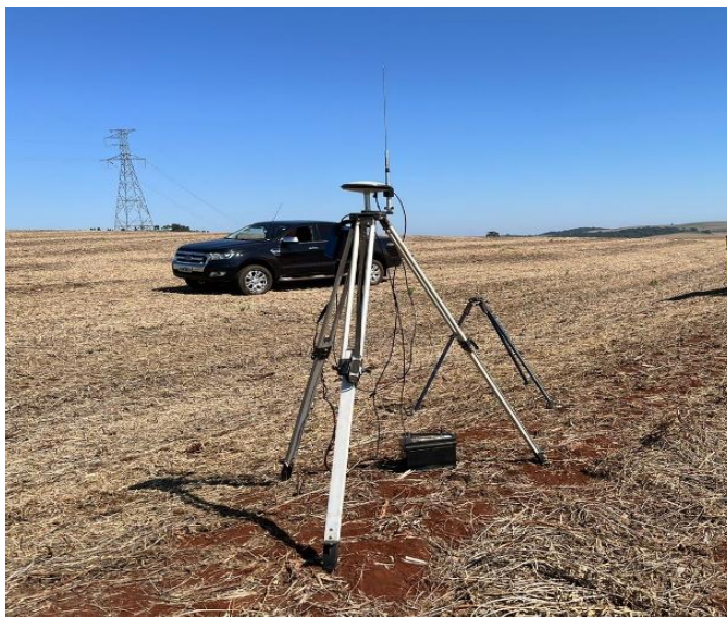
Figura 9 - Equipamento utilizado no georreferenciamento dos pontos de apoio
