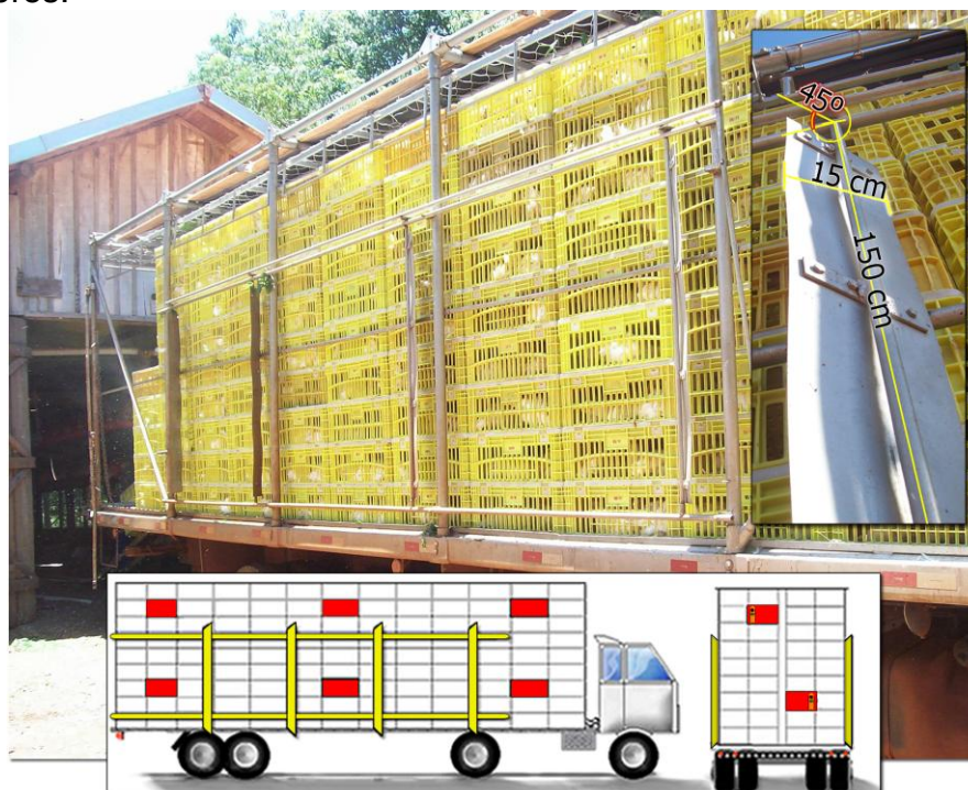
Figura 8 - Foto da vista lateral do protótipo de carroceria e esquema de posição dos defletores.
