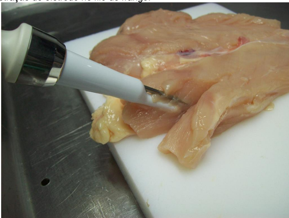
Figura 6 - Análise de pH destacando local inserção e profundidade de penetração do eletrodo no filé de frango.
