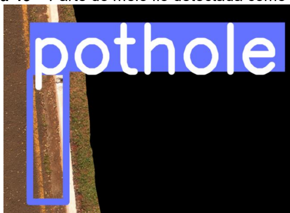
Figura 43 – Parte do meio fio detectada como buraco
