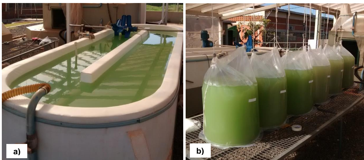
Figura 2 – Sistemas de cultivo de microalgas: (a) sistema aberto; e (b) sistema fechado.
