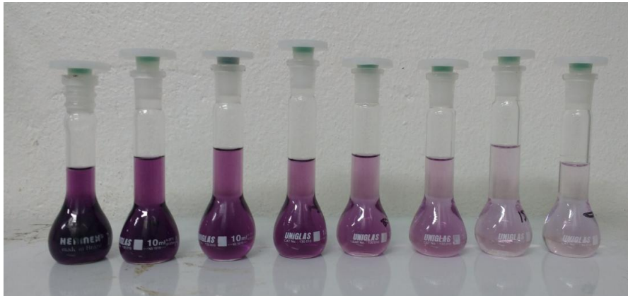
Figura 16. Soluções de ácido-gálico (1 a 120 \mu\text{g/mL} ) para obtenção da curva de calibração.
