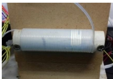
Figura 9 - Câmara de mistura do sistema SIA desenvolvido
