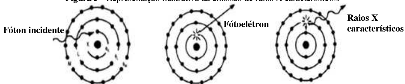
Figura 5 - Representação ilustrativa da emissão de raios X característicos.
