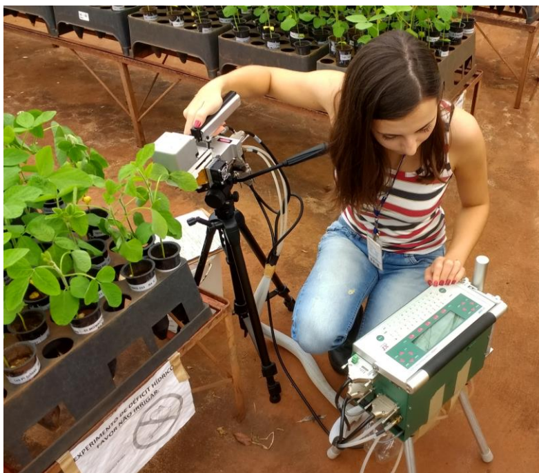
Figura 2. Monitoramento da condutância estomática (gs) da cultivar BR 16 (padrão de referência sensível) com medidor portátil de trocas gasosas.
