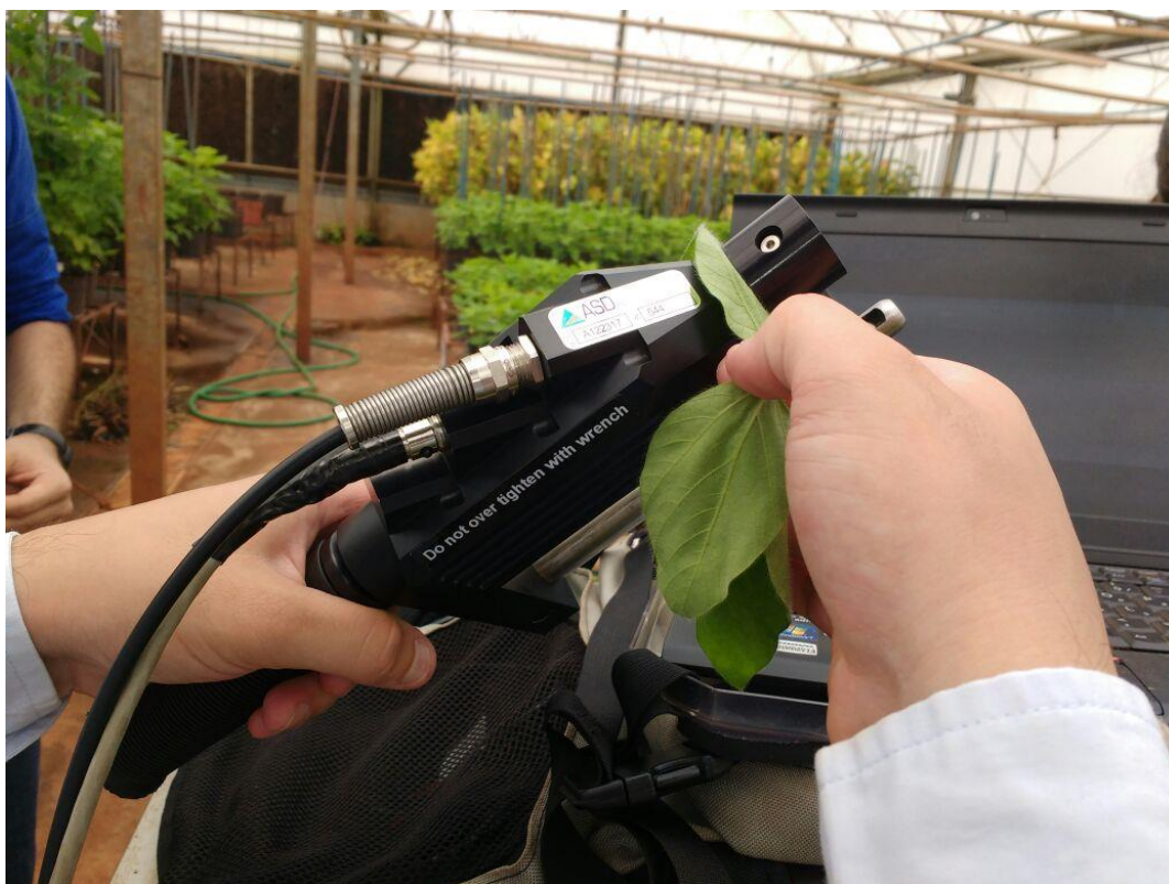
Figura 15. Obtenção dos valores espectrais com uso do sensor hiperespectral Fieldspec 3 Jr, (ASD, Inc.), em detalhe o acessório plant probe do equipamento.
