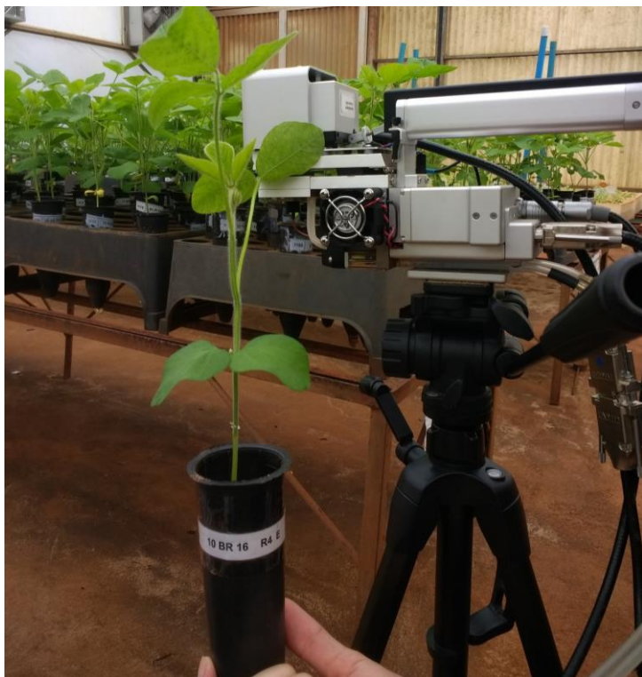
Figura 14. Monitoramento da condutância estomática (gs) da cultivar sensível à seca, BR 16 com uso de medidor portátil de trocas gasosas LI-6400 (LiCor, Inc.).
