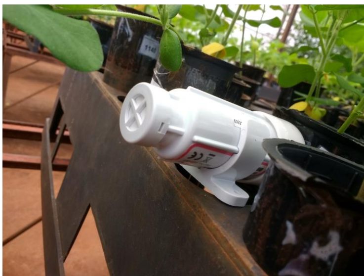
Figura 13. Monitoramento da temperatura e umidade relativa do ar (UR%) com utilização de registrador de dados de termohigrógrafo (modelo U14-002, Hobo Onset®).
