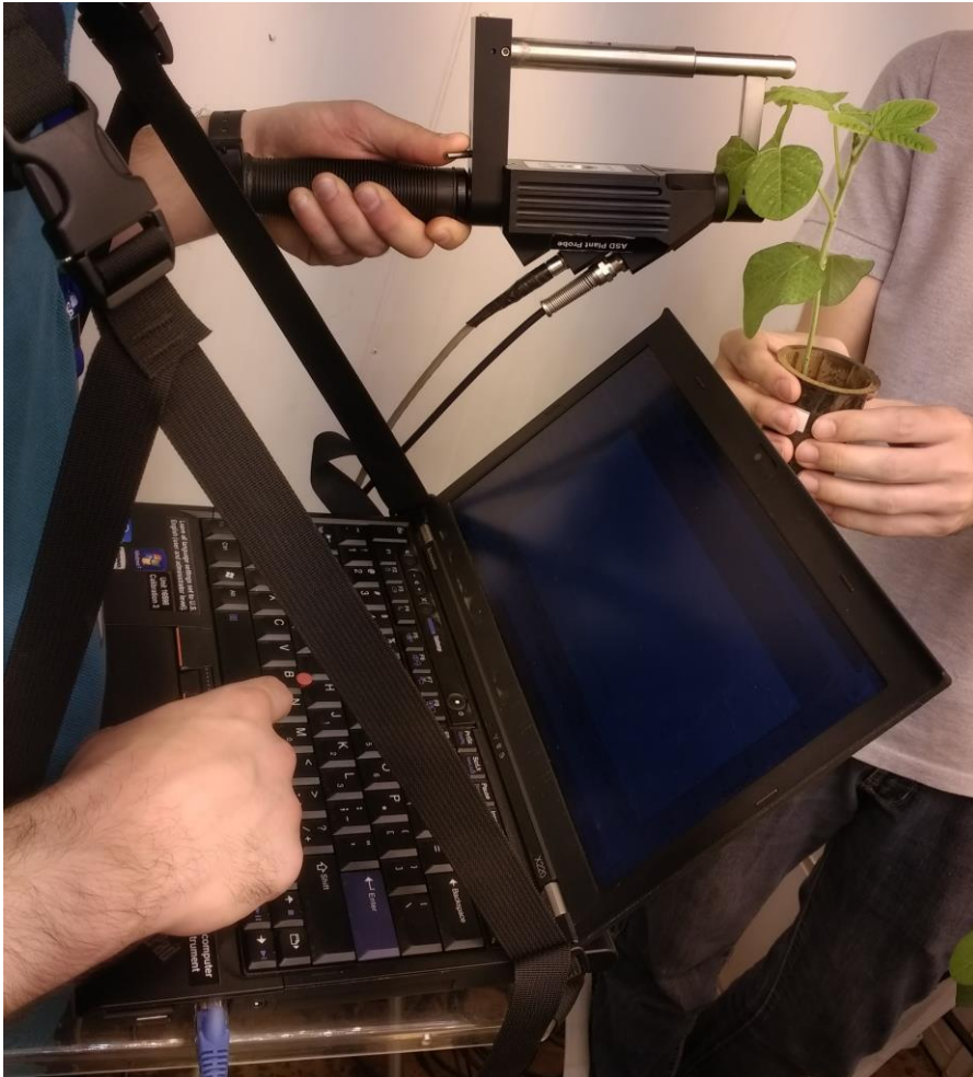
Figura 3. Obtenção dos valores espectrais com uso do sensor hiperespectral para posterior cálculo dos índices de vegetação (IVs) e bandas espectrais.
