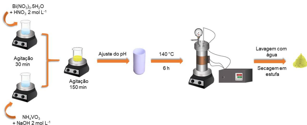
Figura 25 – Esquema do processo de síntese por sistema hidrotérmico dos fotocatalisadores de \text{BiVO}_4
