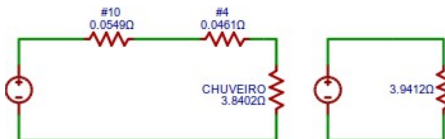
Fig.52- Circuito Série de um chuveiro com cabo #4
