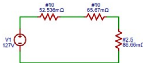
Fig. 20- Circuito do curto Fase Neutro
