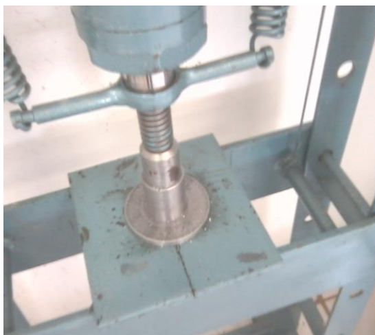
Figura 33 - Prensagem da argamassa para moldagem do corpo de prova, em câmara de aço para suportar 50 MPa de pressão
