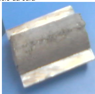
Figura 36 - O corpo de prova moldado sob pressão pode ser imediatamente manipulado para início da cura
