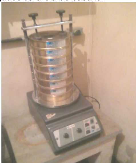
Figura 19 - Ensaio de granulometria para caracterização dos agregados da areia de basalto.
