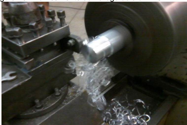
Figura 20 - Torneamento do Tarugo de alumínio
