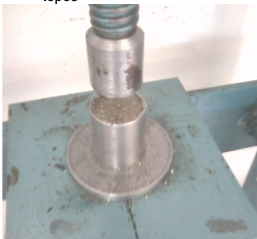
Figura 34 - Corpo de prova com dimensões de 25 x 50 mm, prensado e pronto para regularização da superfície dos topos
