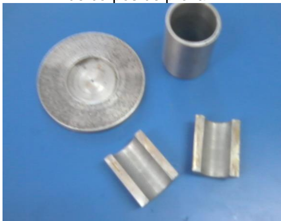
Figura 37 - Peças que compõem o molde destinado à moldagem de corpos de prova.
