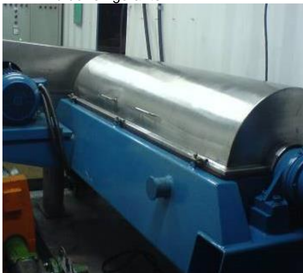
Figura 24 - Enxágue e centrifugação das fibras aparadas para retirada do fluido refrigerante
