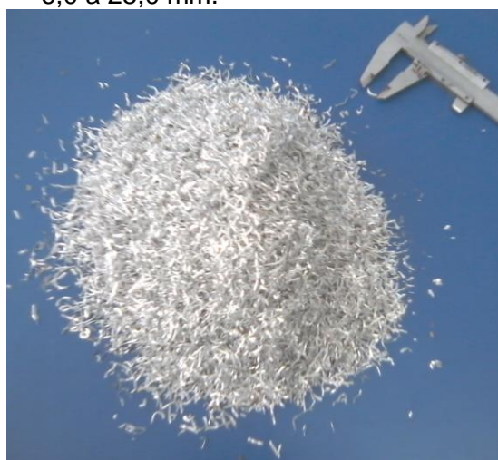
Figura 56 - Fibras de alumínio reciclado, produzidas a partir da usinagem de tarugos de alumínio, com fator de forma lamelar, o comprimento varia de 6,0 a 25,0 mm.
