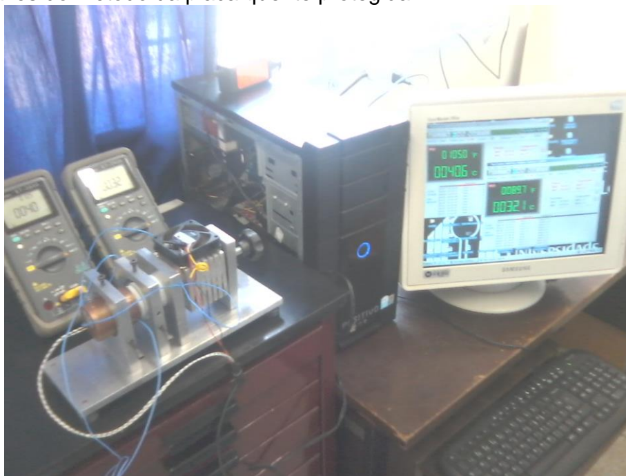
Figura 59 - Bancada utilizada na medição da condutividade térmica da argamassa, através do método da placa quente protegida.
