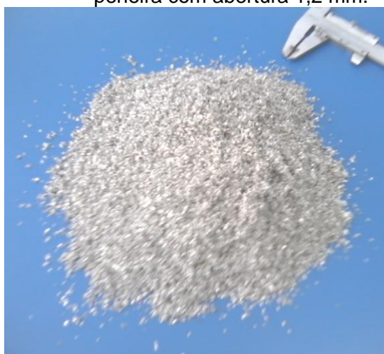
Figura 55 - Partículas de alumínio reciclado, produzidas a partir da serragem do corte de tarugos de alumínio, transpassadas na peneira com abertura 1,2 mm.
