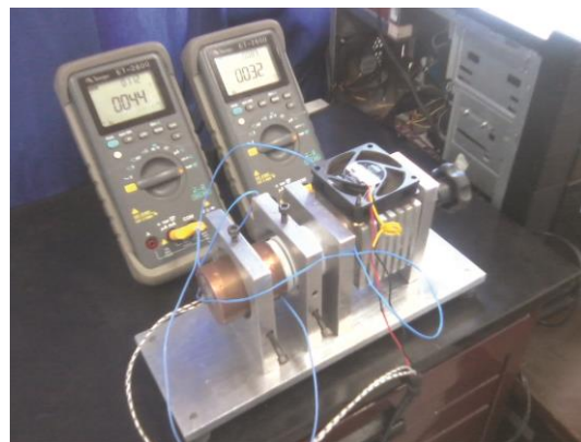
Figura 58 - Coleta de dados, com dispositivo refrigerado, utilizando Termopares do tipo K nas placas quente e fria
