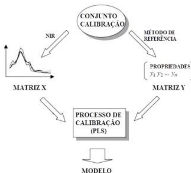
Fig. 14 – Esquema do processo de calibração pelo método PLS.
