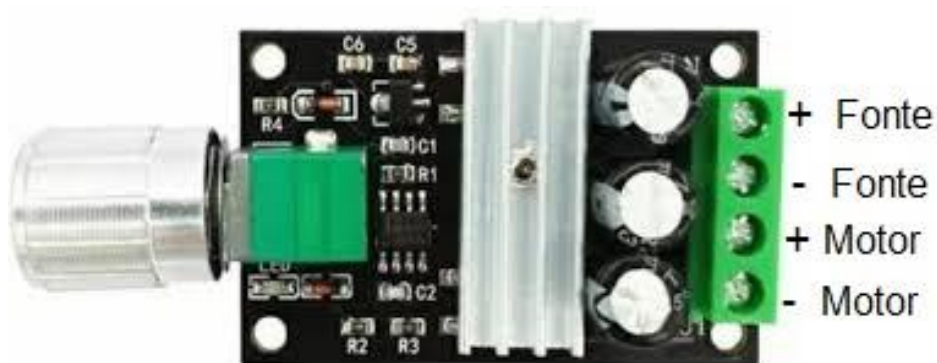
Fig. 22 - Controlador de Velocidade Motor DC
