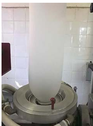
Figura 12 – Balão formado durante o processo de extrusão-sopro de blendas amido/PBAT.
