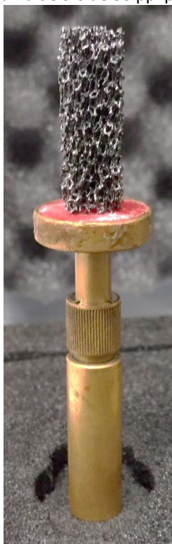
Figura 26 – Fixação da espuma de SiC de 30 ppi para o processo de aquisição de imagens.
