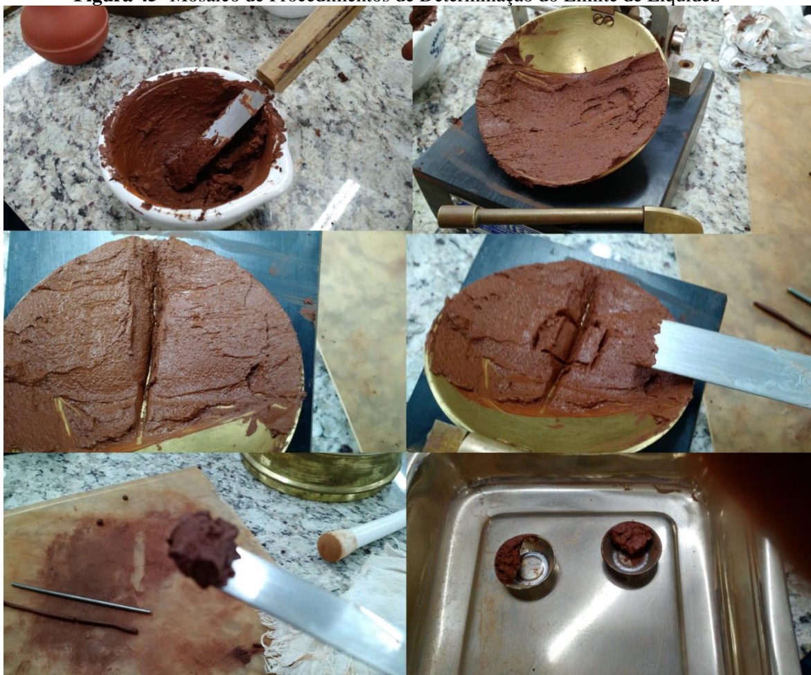
Figura 45- Mosaico de Procedimentos de Determinação do Limite de Liquidez
