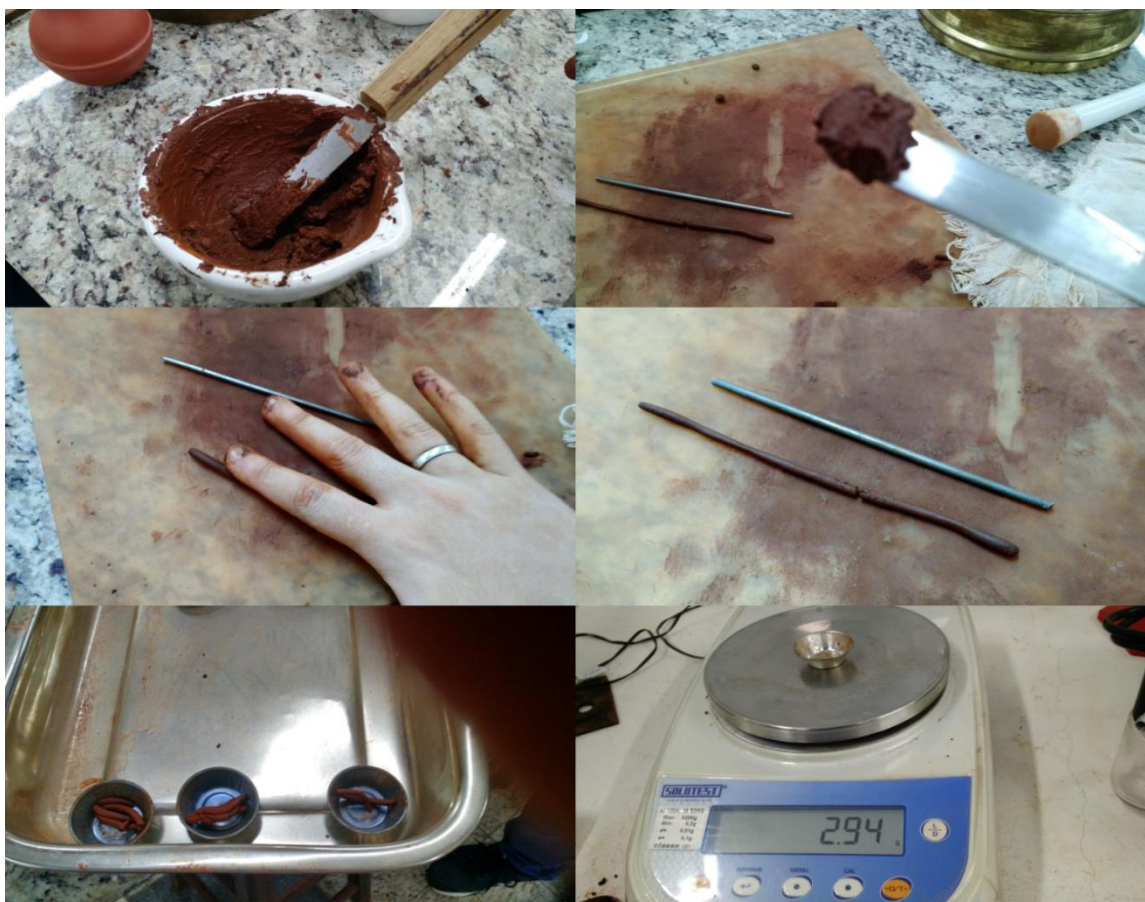
Figura 46 – Mosaico de Procedimentos para Obtenção do Limite de Plasticidade.
