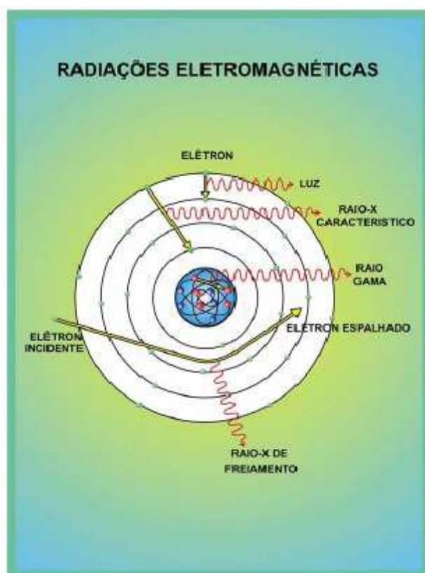
Figura 9 – Transições eletrônicas, produção de raios-X, Gama e luz. Fonte: OBSERVATÓRIO NACIONAL (2004).
