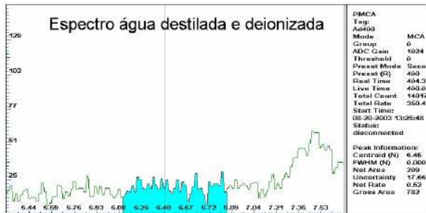
Figura 26 – Espectros da água pura, análise da área da água pura no software PMCA
