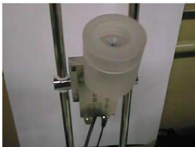
Figura 20 – O detector XR-100CR, da AMPTEK inc e o suporte acrílico para acoplamento da fonte e amostra.
