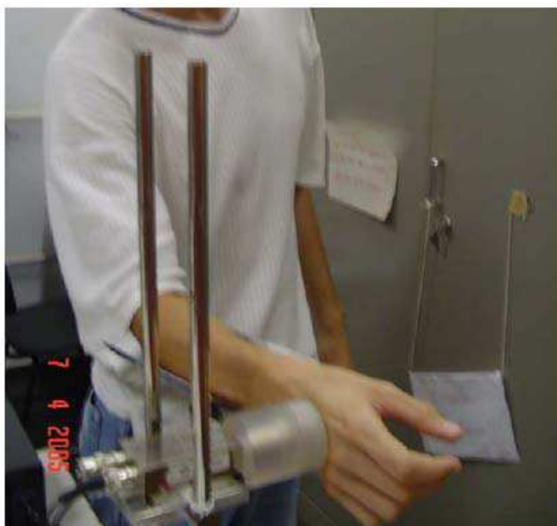
Figura 34 – Medida de XRF in vivo na pele da mão.
