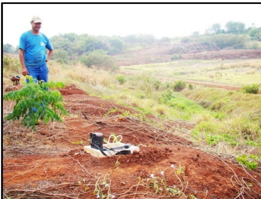
Figura 3.13: Monitoramento do biogás que vaza pela camada de superfície por meio dos ensaios com placa estática de fluxo no aterro de Londrina (segunda e terceira campanhas de medidas)
