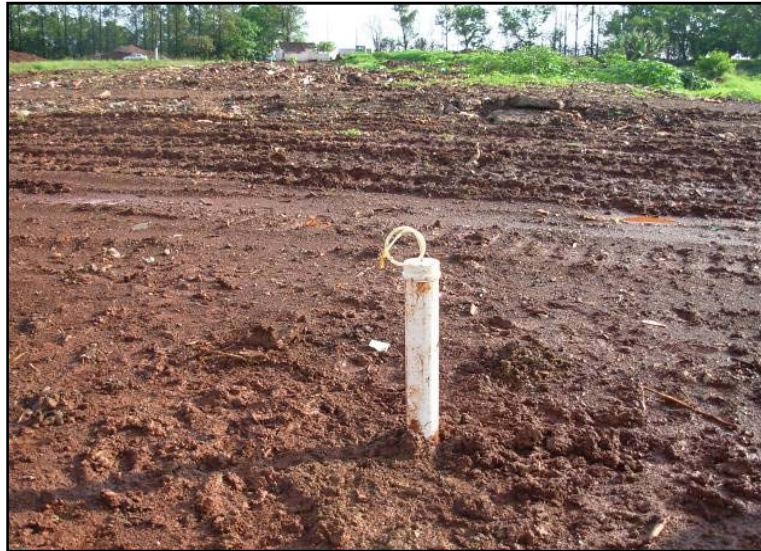
Figura 3.9: Vista de ensaio com tubo de inspeção para monitoramento dos gases sob a camada de cobertura do aterro de Londrina
