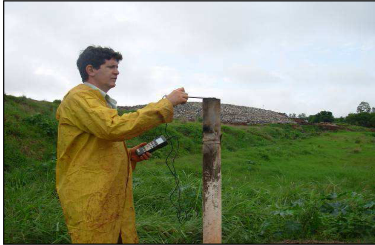
Figura 3.10: Medições executadas em drenos verticais no aterro de Londrina Fonte: MACIEL et al (2009)
