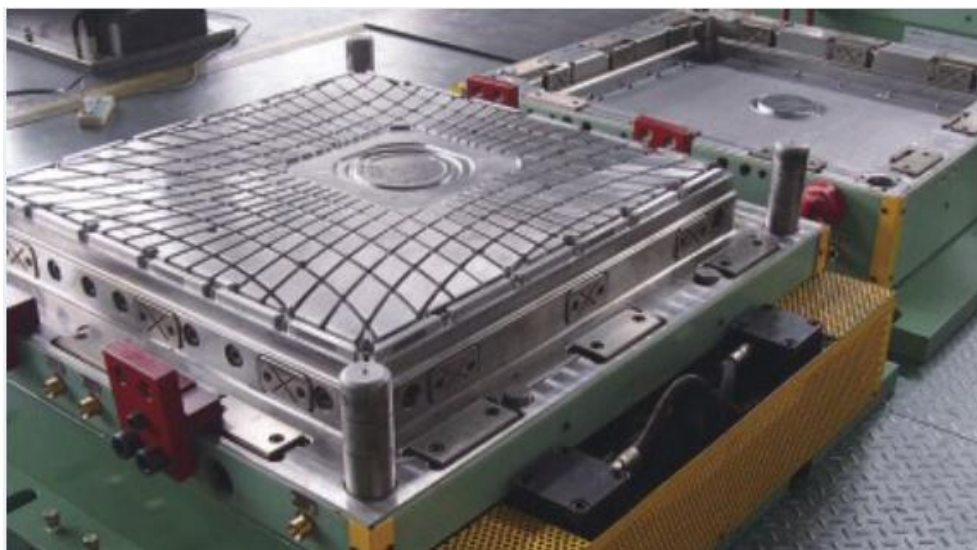
Figura 38 – Molde de alumínio para equipamento SMC
