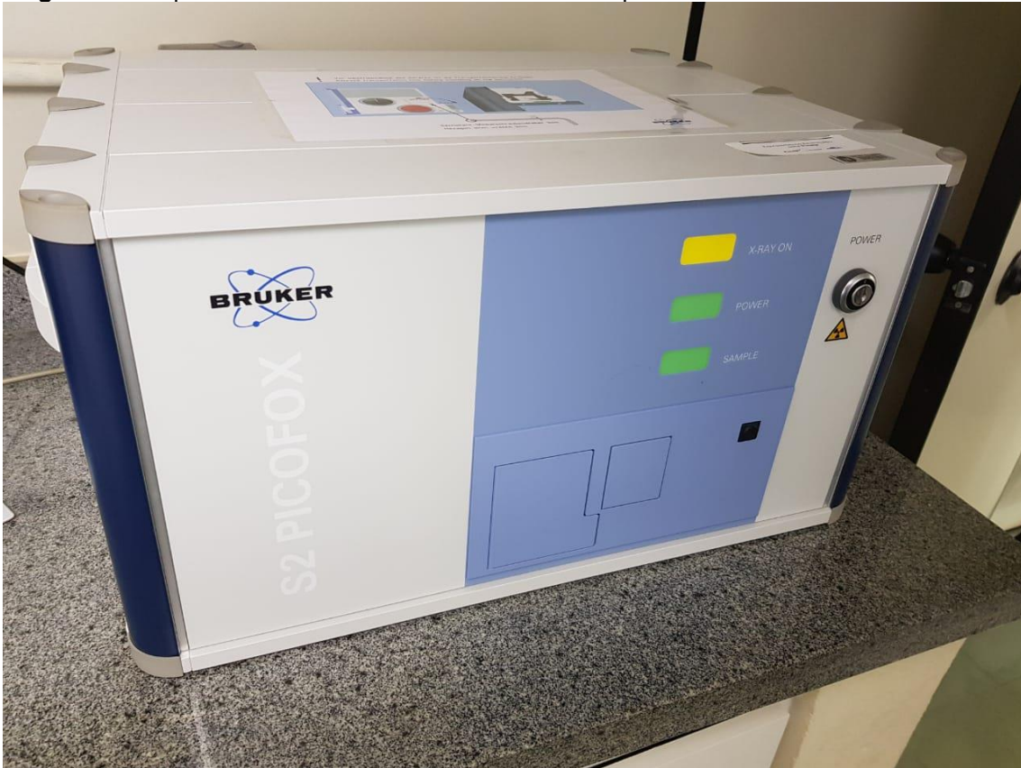
Figura 14 - Espectrômetro de Fluorescência de Raios X por Reflexão Total S2PICOFOX da Bruker.
