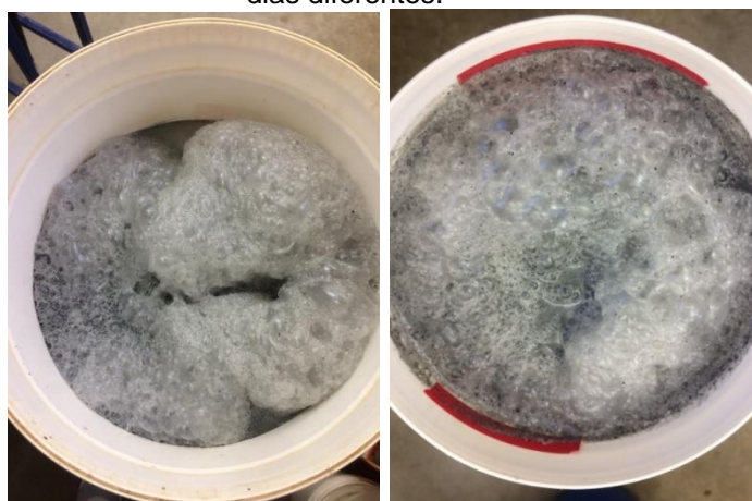
Figura 14 - Efluente do reator com a camada de gordura formada durante o processo anaeróbio, em dias diferentes.
