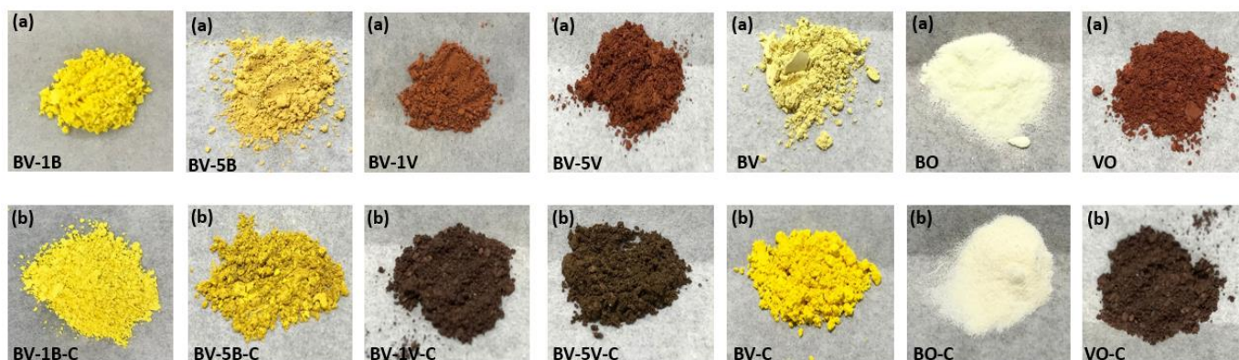
Figura 13 – Fotografias dos materiais sintetizados (a) sem tratamento térmico (b) com tratamento térmico de 450°C/2h.
