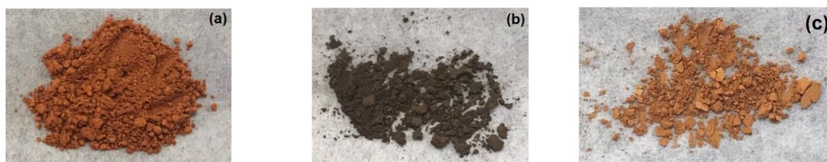
Figura 34 – Sequência das cores do óxido VO após processo de adsorção/dessorção (a) VO antes da adsorção seletiva, (b) após adsorção do corante AM pH 8,0 e (c) após dessorção pH1,0.
