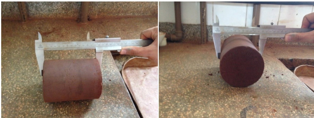
Figura 23 - Determinação das dimensões do corpo de prova de solo-cimento após 4 horas de imersão em água
