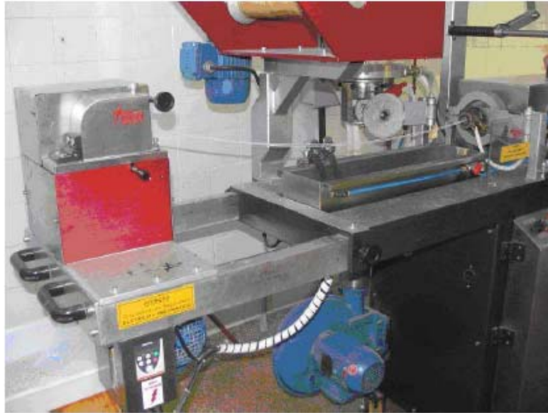
Figura 3.1 – Extrusora utilizada na produção dos pellets e filmes de PBAT e amido termoplástico (ATp).
