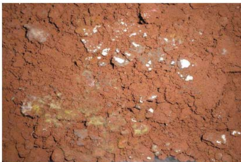
Figura 4.21 – Imagem do solo onde os filmes foram enterrados, ao final do processo de biodegradação (150 dias).
