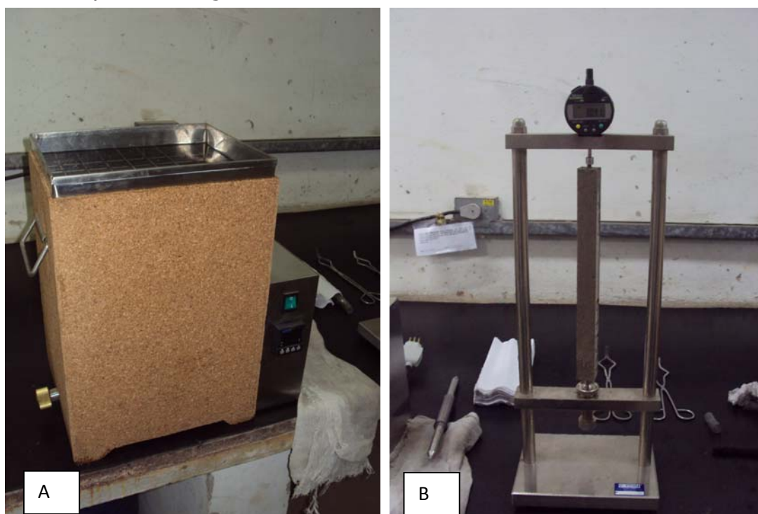
Figura 5.8 –a) Banho termorregulador ajustado para 80° C; b) Registro da tomada do comprimento inicial das barras de argamassa. A mesma operação se repetiu ao longo do ensaio.
