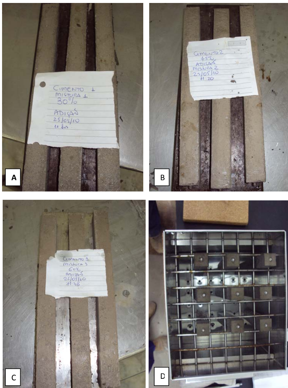
Figura 5.7 – De A) a C) Barras de argamassa após a desmoldagem; D) Barras de argamassa em banho termo regulador a 80°C.
