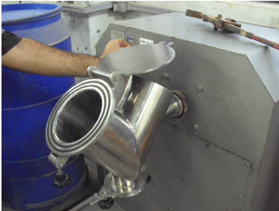
Figura 5.4 –Misturador tipo “Y” utilizado para a mistura das amostras micronizadas de basalto BL e BA a fim de aumentar o volume de material disponível para realização dos ensaios.
