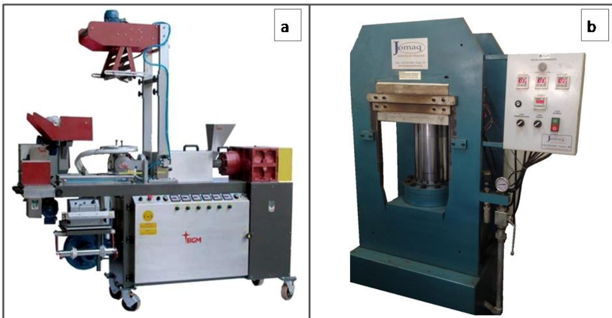
Figura 6 - Equipamentos utilizados para produção dos laminados: a) extrusora monorosca e b) termoprensa.
