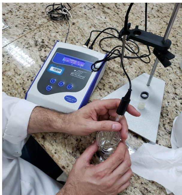
Foto 7: Análise de pH com pHmetro digital.
