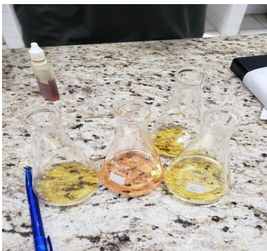
Foto 3: Padronização da solução de titulação para análise de acidez titulável
