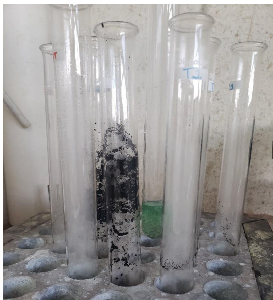
Foto 5: Análise de proteínas – processo de digestão.
