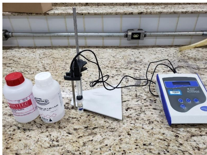
Foto 8: Soluções tampão e pHmetro utilizados na análise de pH.
