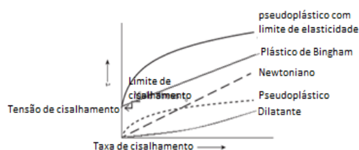
Figura 3 - Viscosidade por tensão de cisalhamento por dos diferentes fluidos.
