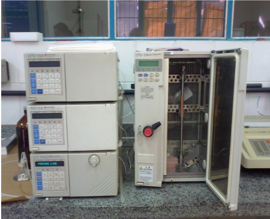
Figura 8 - Bomba LC-10AD, forno CTO-10A, detector de índice de refração RID-10A e integrador C-R6A.
