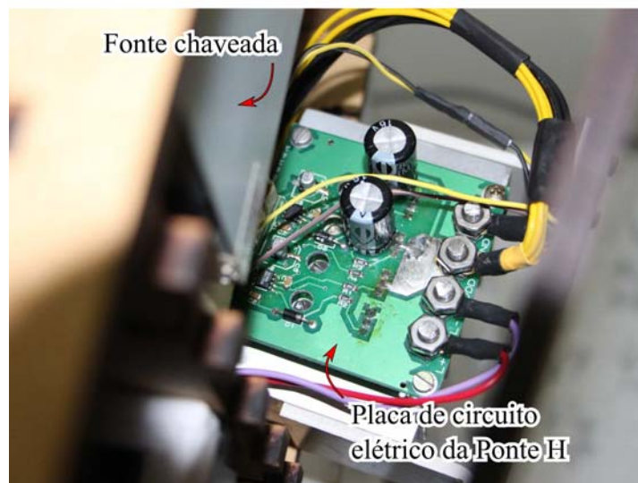
Figura 4.4: Ponte H e fonte chaveada.
