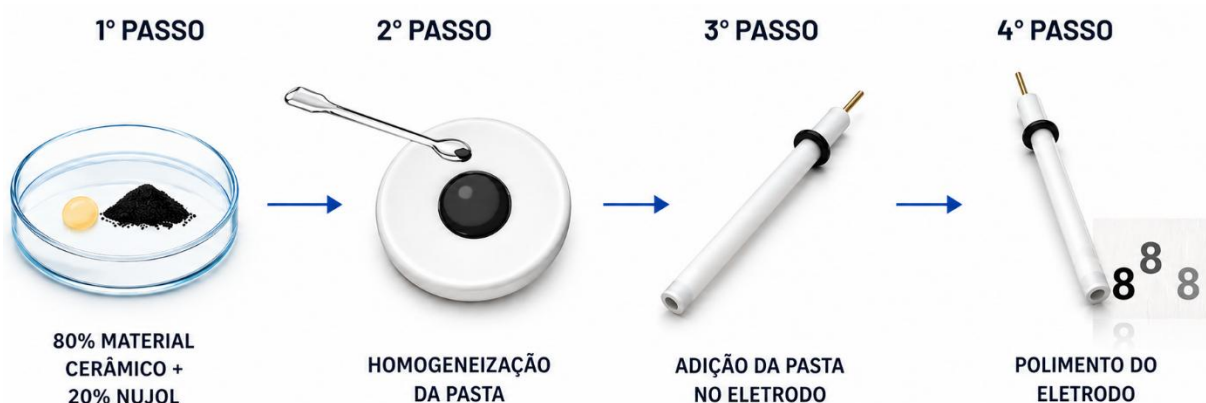
Figura 3 – Representação da confecção dos eletrodos de trabalho contendo o material cerâmico e Nujol, na proporção 80:20 (m/m) cerâmica:Nujol.
