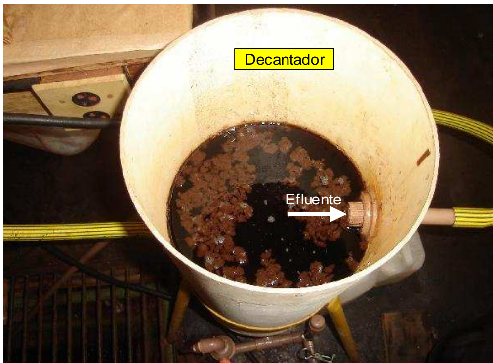
Figura 5.10 – Flotação ocorrida no decantador secundário, após o início da Fase III.
