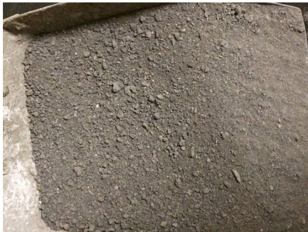
Figura 13 – Agregado miúdo siderúrgico de escória de aciaria de forno elétrico
