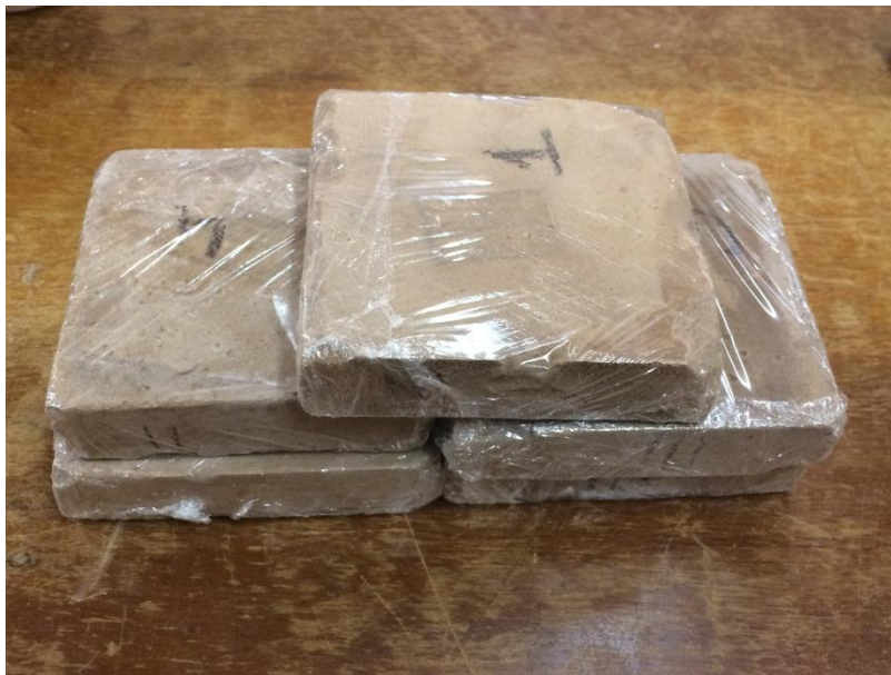
Figura 28 – Amostras para o ensaio de atenuação de radiação seladas com plástico PVC
