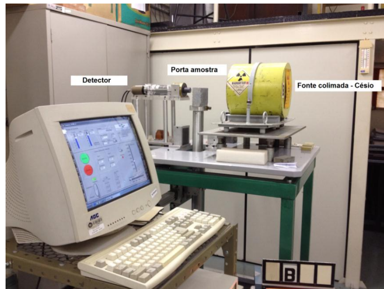
Figura 32 - Mesa micrométrica usada para obter o coeficiente de atenuação de radiação gama das argamassas
