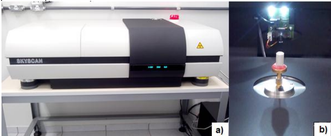
Figura 16 – a) Aparelho de micro-CT SkyScan 1172 b) Posicionamento da amostra de pasta no aparelho
