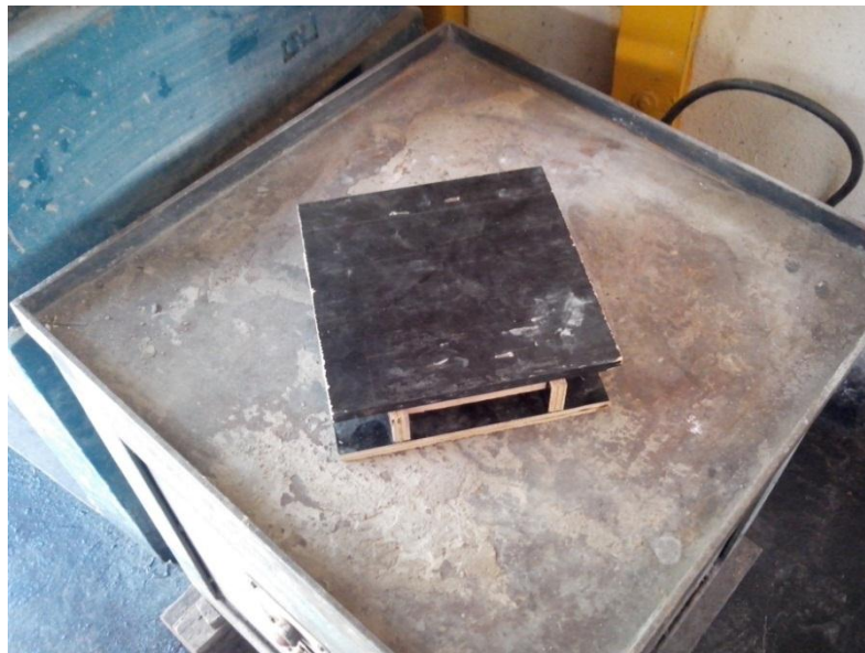
Figura 25 – Adensamento dos corpos de prova na mesa vibratória
