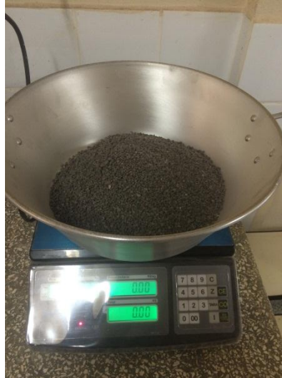
Figura 21 – Pesagem das frações para montagem da areia
