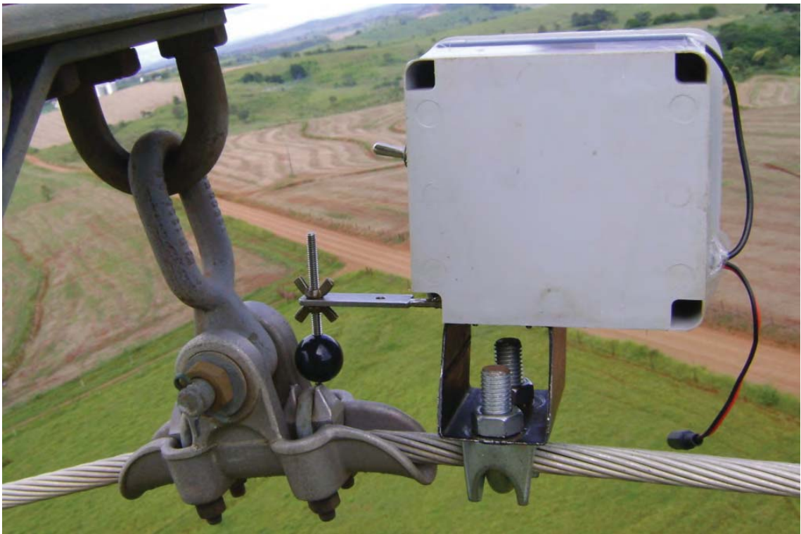
Figura 4.5 – Montagem do vibrógrafo. Foto: o autor.
