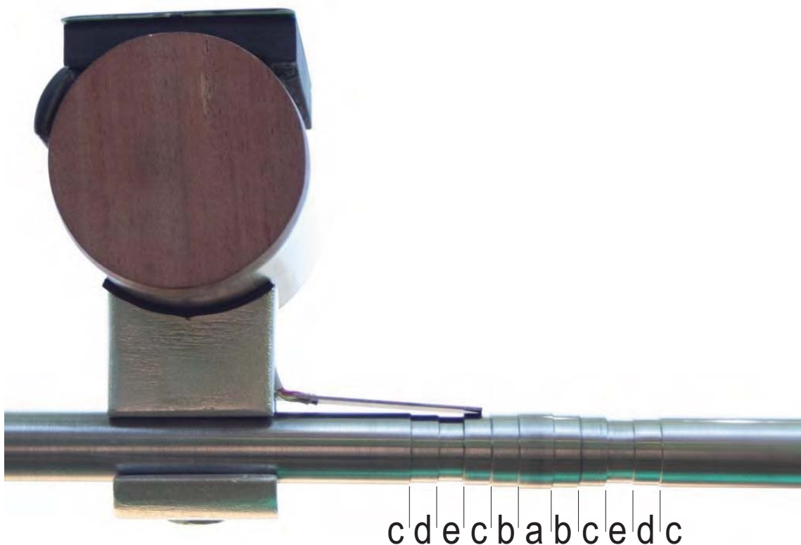
Figura 4.8 – Visualização do “jig”: os locais onde se posiciona a haste sensora para a calibração são representados pelas letras a, b, c, d, e, segundo seus diâmetros.
