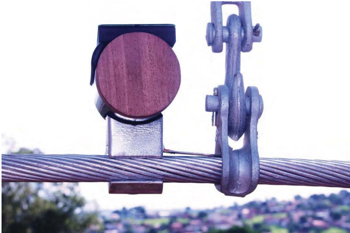
Figura 4.7 – Montagem do vibrógrafo (Protótipo Final) Foto: o autor.
