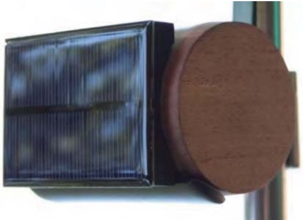
Figura 3.9 – Visão superior mostrando painel solar e antena - Protótipo Final.
