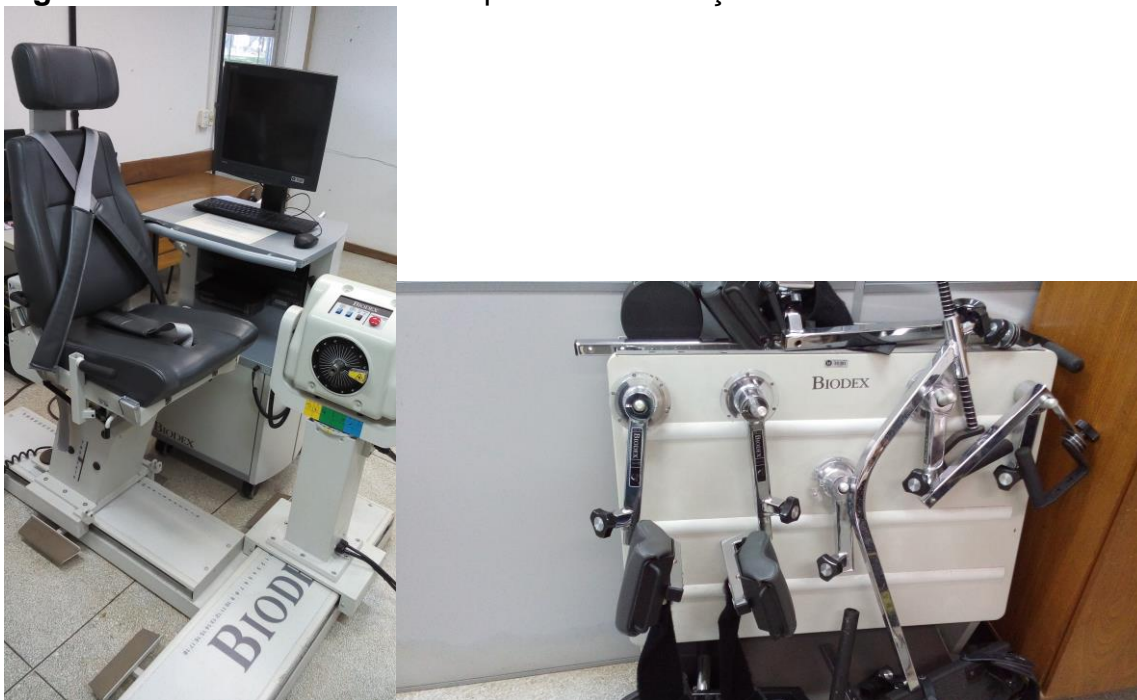
Figura 1 - Dinamômetro utilizado para medir a força muscular isocinética
