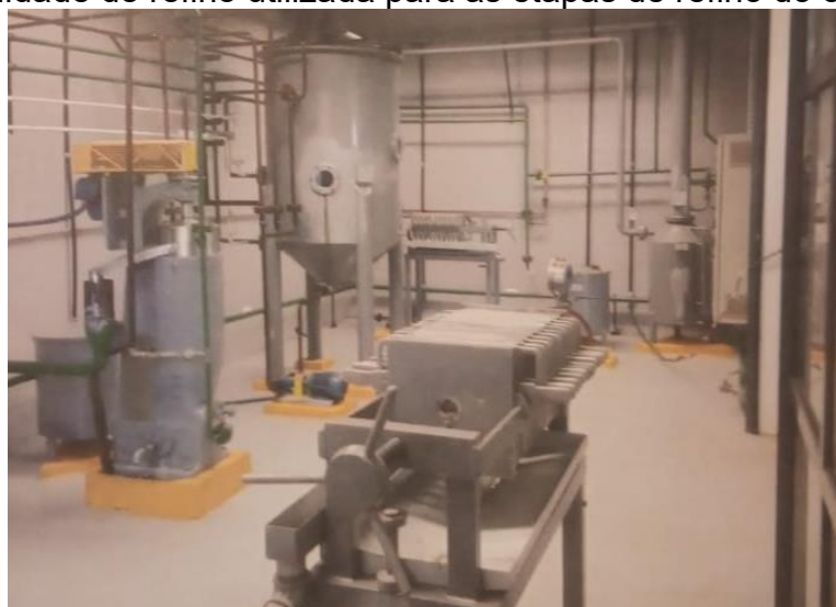
Figura 16: Unidade de refino utilizada para as etapas de refino do óleo de Crambe
