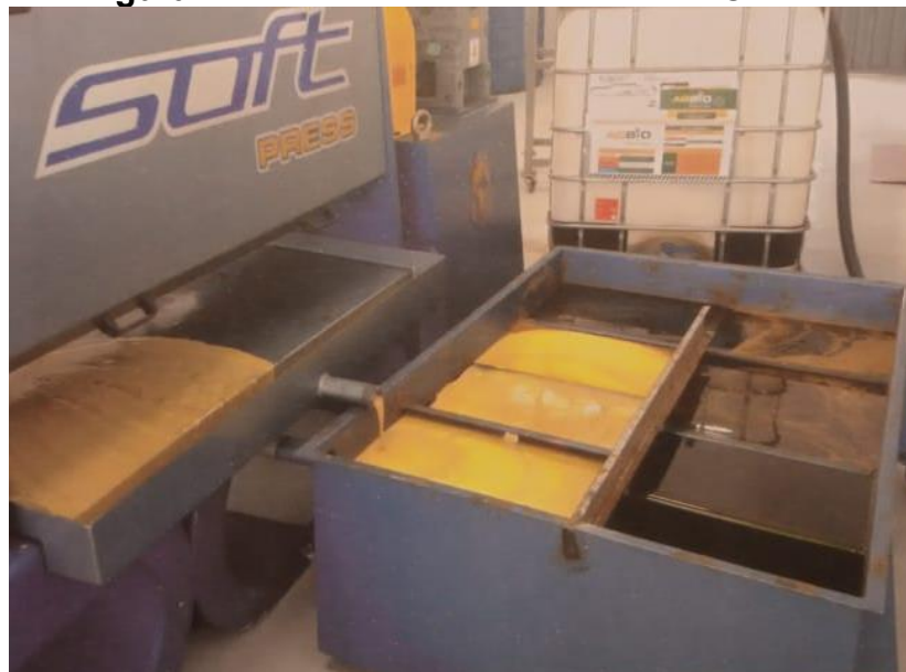
Figura 12: Decantador do óleo bruto de Crambe
