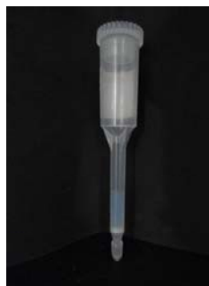
Figura 19 –CIA desenvolvida em coluna de polipropileno (Muromac Columns, Japão) com 5mg de Ac por mL de gel/0,5 mL de gel.
