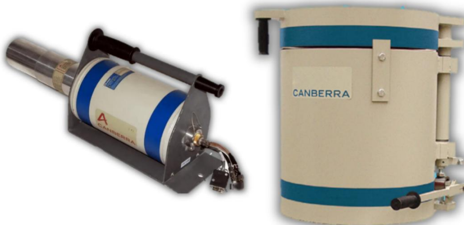
Figura 42 – Detector HPGe e a blindagem utilizada.
