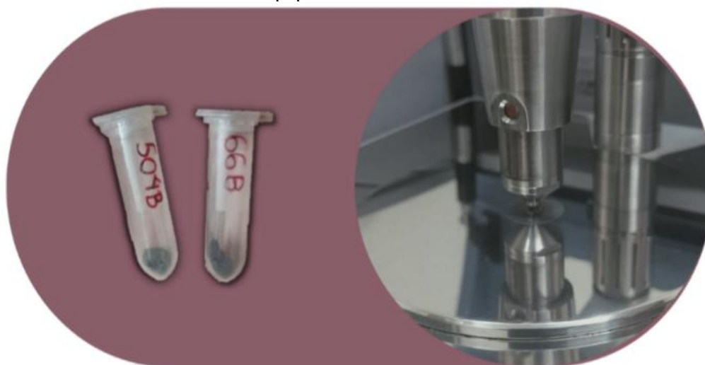
Figura 39 – Eppendorf contendo pó de cerâmicas, e a amostra sendo medida no equipamento de FTIR.
