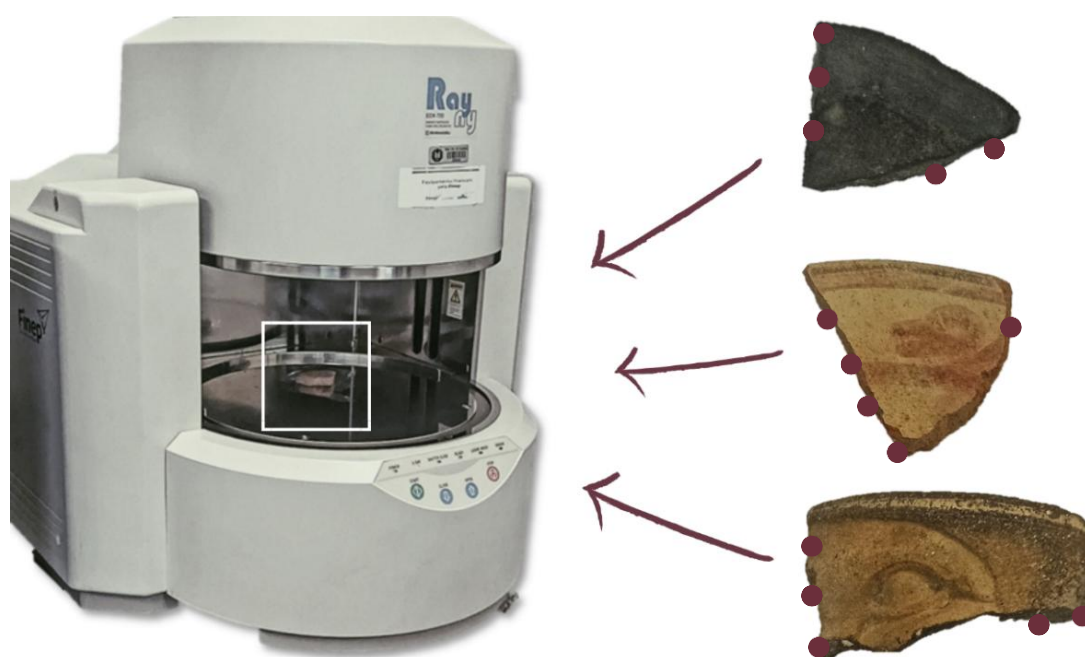
Figura 33 – Equipamento Shimadzu EDX-720 com fragmento cerâmico dentro, ilustrando como é realizado a medida. Os pontos coloridos representam a área da pasta onde a medida foi realizada.
