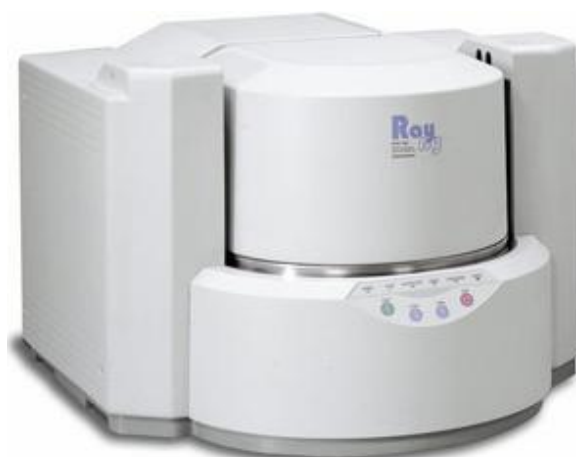
Figura 32 – Equipamento Shimadzu EDX-720 no LARX da UEL.
