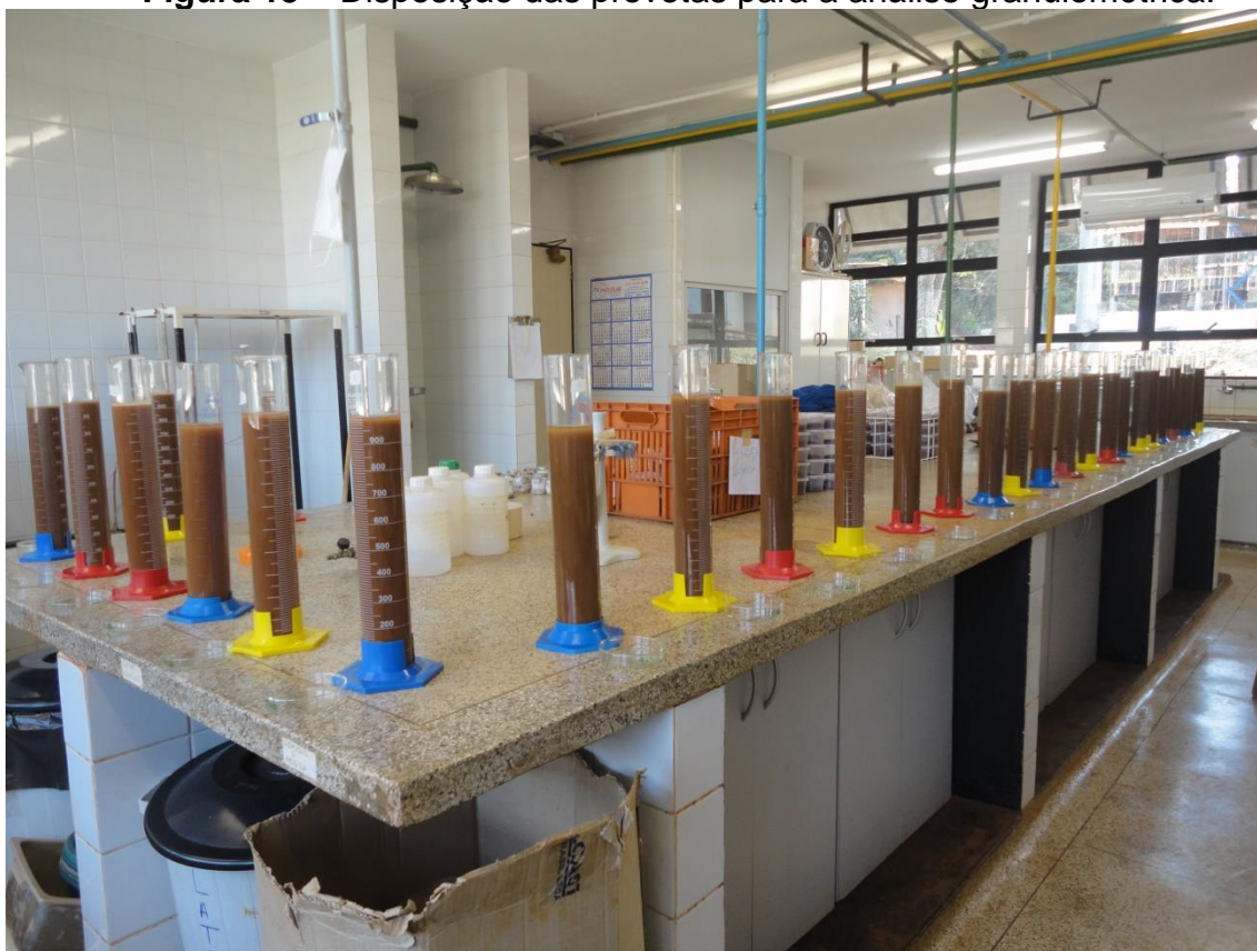
Figura 15 – Disposição das provetas para a análise granulométrica.
