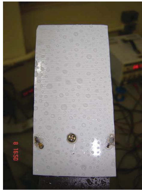
(b) Sensor coberto com tinta esmalte ( Cap\#(5,6) );
