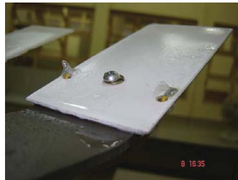
(d) Sensor coberto com tinta latex ( ResLTx\#(7,8) ).
