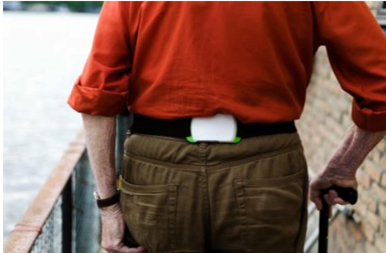
Figura 3- Posicionamento correto do aparelho DynaPort MoveMonitor.
