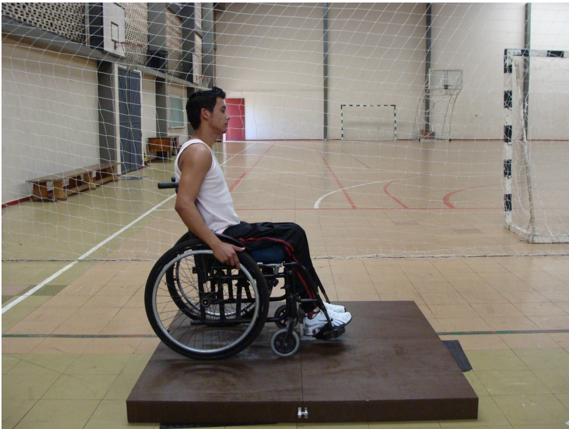
Figura 12 – Avaliado executando o teste de traspôr de graus, colocando apenas as rodas dianteiras sobre a plataforma
