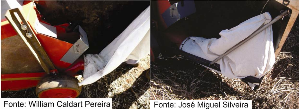
Figura 3.3 – Saco adaptado na parte frontal do protótipo para coleta do material trilhado.
