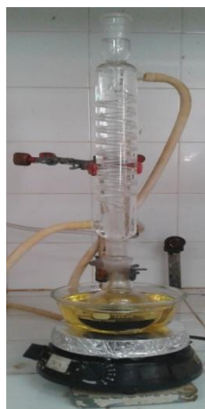
Figura 11 – Sistema utilizado para a oxidação dos MWCNT.
