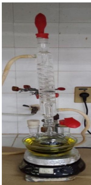
Figura 12 – Sistema utilizado para a funcionalização dos MWCNT-OXI.
